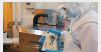
品質表示のモレや不純物の混入がないか、パッケージにした状態で確認します。
